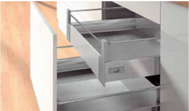
Внутренняя система выдвижения с релингом, высота задней стенки 144мм Номинальная длина направляющих 260, 350, 420, 470мм Высота боковины 144мм
