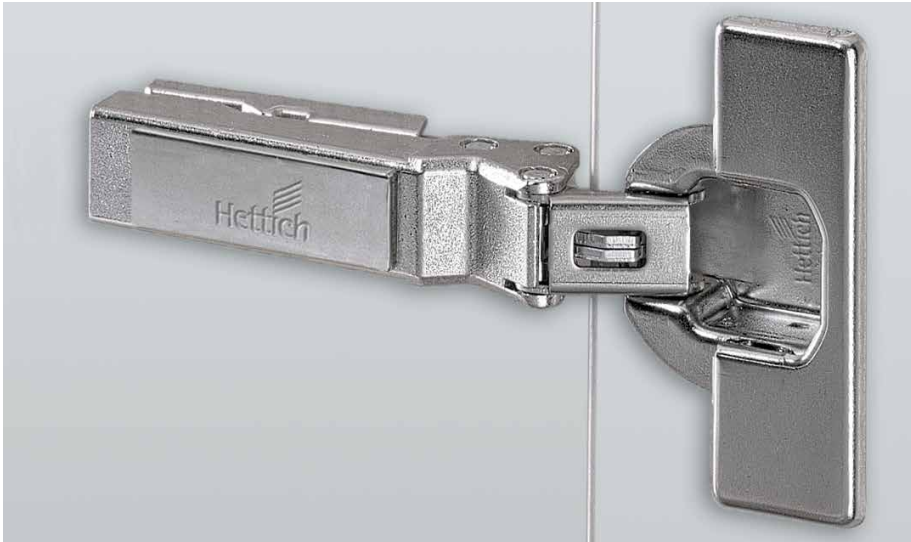
W-30 накладная петля (угол открывания 125°, угол корпуса -30°) W-30 full overlay negative angle hinge (opening angle 125°, for -30° face angle) W-30 Negativ-Winkelscharnier voll vorliegend (Öffnungswinkel 125°, für Korpuswinkel -30°)
