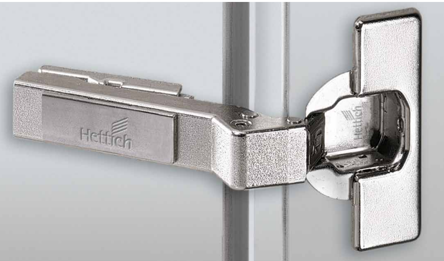
W-45 накладная петля (угол открывания 125°, угол корпуса -45°) W-45 full overlay negative angle hinge (opening angle 125°, for -45° face angle) W-45 Negativ-Winkelscharnier voll vorliegend (Öffnungswinkel 125°, für Korpuswinkel -45°)
