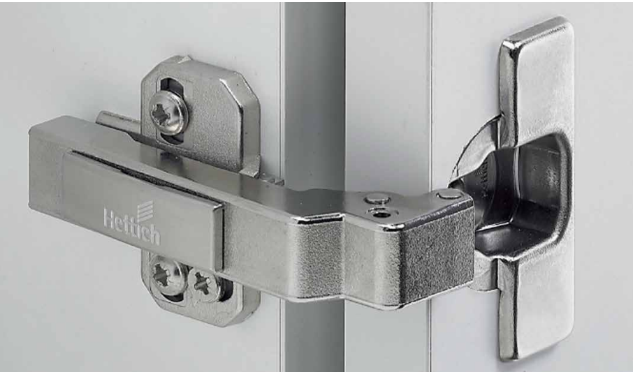
W-45 накладная петля (угол открывания 125°, угол корпуса -45°) W-45 full overlay negative angle hinge (opening angle 125°, for -45° face angle) W-45 Negativ-Winkelscharnier voll vorliegend (Öffnungswinkel 125°, für Korpuswinkel -45°)
